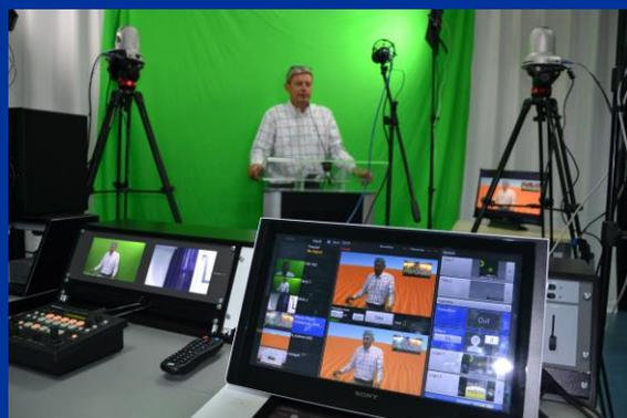
Cette technologie, appelée également « Chromakey », permet le découpage de l'avant plan (l'orateur) et sa projection sur n'importe quel fond de type image fixe ou film.
